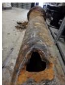
腐食した工業用配水管の例
