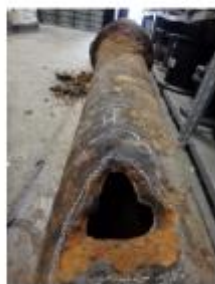
腐食した工業用配水管の例
