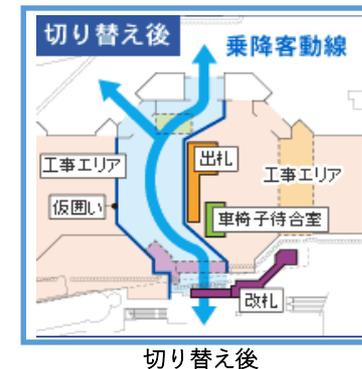
工事中の東京駅動線図。駅舎としての機能を止めずに工事を進めるため、南口・北口・中央改札口へのアプローチを変更しながら、乗客数の安全を確保して工事が進められた。工事の進捗に伴い、駅機能に必要な業務施設などは、移設しながら施工、南口の例については右を参照。
