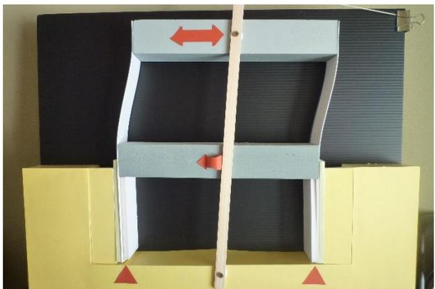
擁壁の外部の土が「剛」であれば(左下)、日建の計算モデル(左上)に近い。
